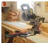
Scie circulaire radiale | Machine-outil constituée d'une lame de scie circulaire mobile montée sur un support d'angle réglable. Elle est manipulable au moyen d'une poignée et elle permet d'effectuer des coupes transversales droites ou d'onglet.                                                                    |
