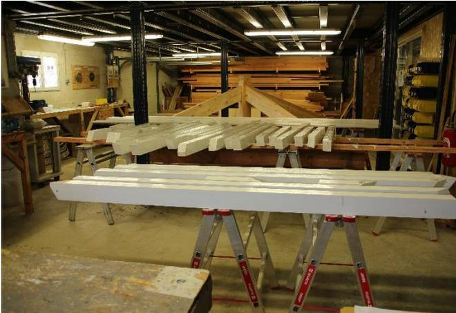
Pour faciliter la mise en peinture de l'ouvrage, celle-ci est réalisée en atelier sur tréteaux.
