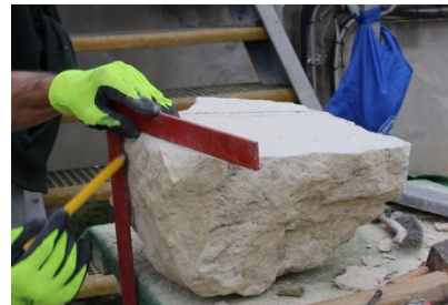
Traçage des arêtes de la face de référence à l'aide d'une équerre*.
